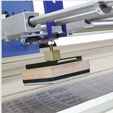
Schleifschuh mit Kugelschnellklemmung.
