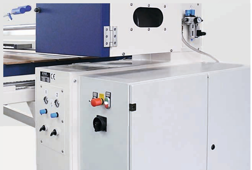
Rechter Maschinenständer mit Kröpfung, Schalter und Druckregler für pneumatische Bandspannung. Von vorn bedienbar.
