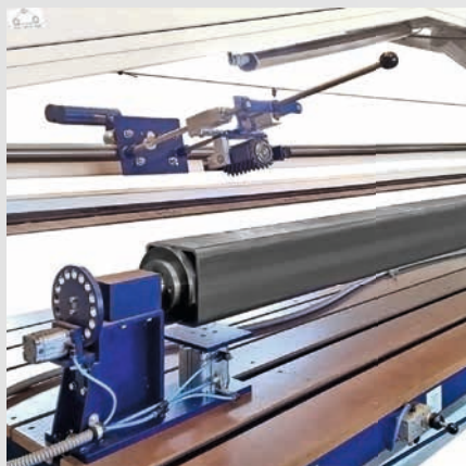
Auf dem Maschinentisch montierte pneumatisch betätigte Werkstückspann- und Drehvorrichtung.
