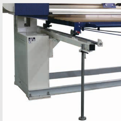
Stützen für Tischführungsholme bei Tischlasten bis 400 daN
