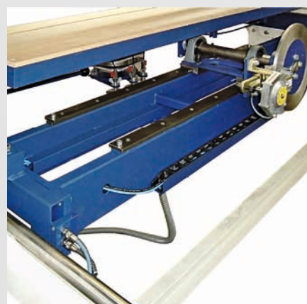
3D-Handlingvorrichtung über Führungen von der Tischmitte zur rechten Tischseite verschiebbar.
