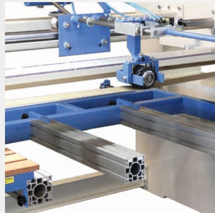
Aluminium Kragarme zur Aufnahme von kastenförmigen Werkstücken.
