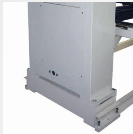
Unterbau zum Vergrößern der Arbeitshöhe.
