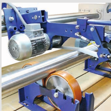
Rohrschleifaggregat bestehend aus dem Querschleifaggregat, einem angetriebenen Rollenbock und einem Rollenbock als Mitläufer.
